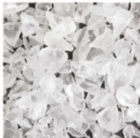
Composés d'un mélange de métaphosphates à haute polymérisation. Les cristaux de polyphosphates ont un aspect vitreux transparent de couleur blanche. Cristaux à dissolution lente, proportionnelle à la granulométrie, température, pH et dureté de l'eau.
