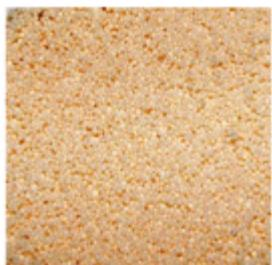
Résine anti-nitrate échangeuse d'ions, sélective pour les nitrates. Anionique base forte macroporeuse. Idéale pour enlever les nitrates même en présence de moyennes / hautes concentrations de sulfates.
