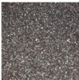
Utilisé pour la réduction du chlore et des composés chlorurés et organiques de l'eau. Pour une utilisation en eau potable, industrielle ou en aquariophilie. Convient pour la filtration des aquariums d'eau douce et d'eau de mer (poissons et récifaux) et des bassins de jardin.
