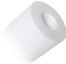
Formées par liaison thermique (thermo-soudure) de microfibres de polypropylène de haute qualité approuvée FDA : certificat NSF. Elles filtrent les particules fines (sable, boue, sédiments, rouille, algues...) avec une faible perte de charge. Fabriquées sans solvants, liants ou additifs, elles ne libèrent aucune matière dans l'eau.
