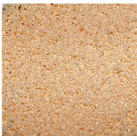
Résine anti-nitrate échangeuse d'ions, sélective pour les nitrates. Anionique base forte macroporeuse. Idéale pour enlever les nitrates même en présence de moyennes / hautes concentrations de sulfates.
