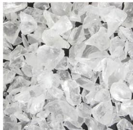
Composés d'un mélange de métaphosphates à haute polymérisation. Les cristaux de polyphosphates ont un aspect vitreux transparent de couleur blanche. Cristaux à dissolution lente, proportionnelle à la granulométrie, température, pH et dureté de l'eau.
