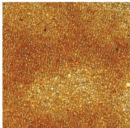
Résine adoucisseur échangeuse d'ions, cationique forte. Idéale pour l'adoucissement en systèmes industriels, commerciaux ou résidentiels sans chlore libre. Son efficacité anticalcaire permet de protéger vos installations et vos canalisations.
